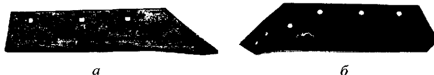
Рис. 1. Лемеха в состоянии поставки: а — лемех отечественного производства; б — лемех Kverneland
