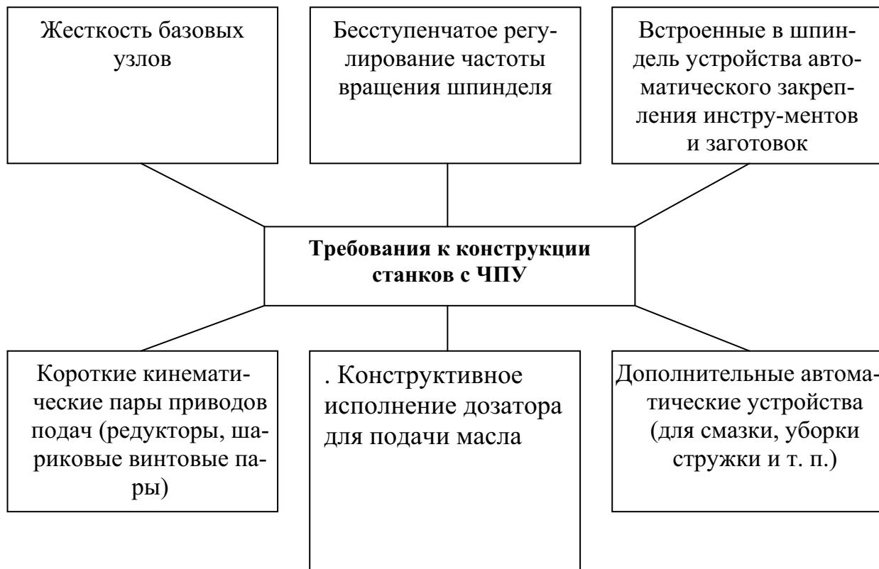
Рис. 1.2. Основные требования к конструкции станка с ЧПУ
