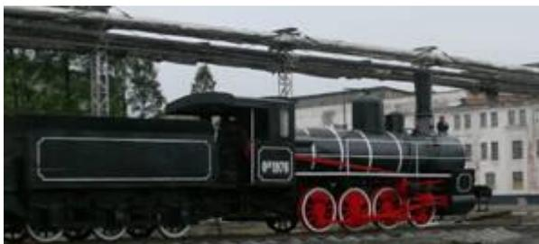
Паровоз серии ОД № 1976 был изготовлен на Брянском заводе в 1899 году. Его вес более пятидесяти тонн. Нагрузка на ось — 13 тонн. Паровоз-труженик прошел многие годы. Пережил Великую Отечественную войну. Работал на Красноярской и Забайкальской
