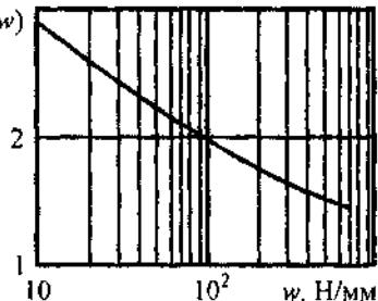
Рис. 1. Зависимость отношения  $\beta(w)$  полуширины площадки контакта по Герцу к полуширине с учетом шероховатости от удельной нагрузки  $w$
