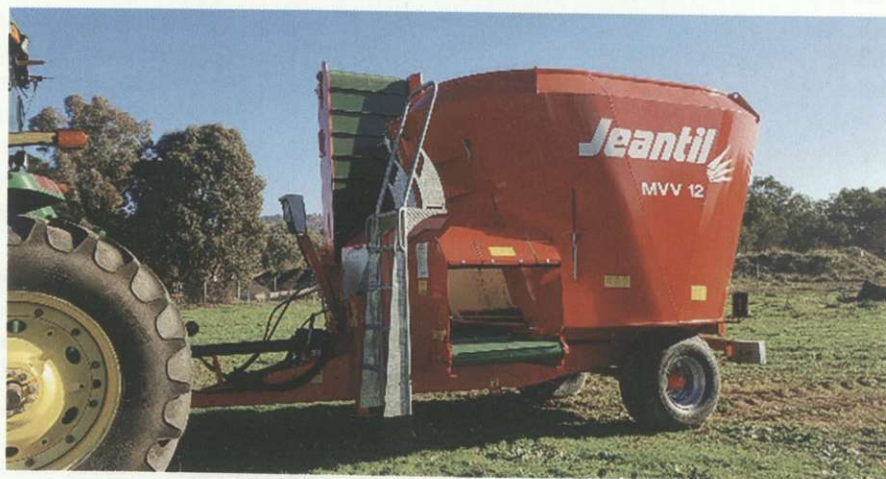
Рис. 5. Мобильный смеситель-раздатчик кормов Jeantil MVV 12 с дополнительным транспортером
