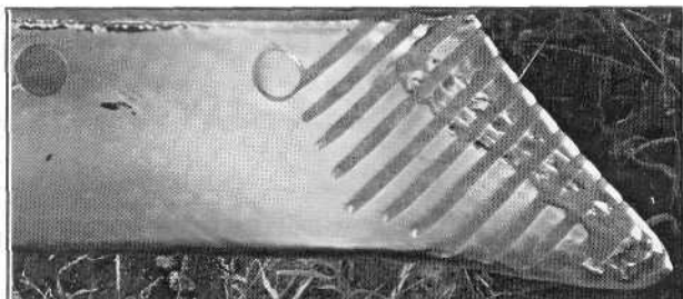
Рис. 3. Носовая часть восстановленного плужного лемеха с пазами, заполненными почвой, и заваренным носком
