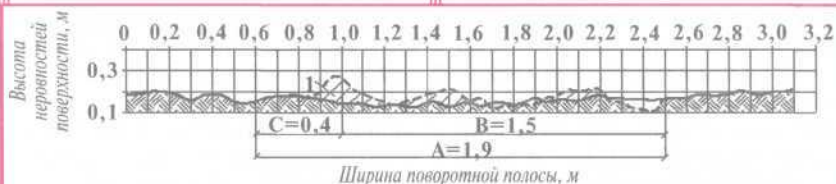
Рис. 3. Поперечное перераспределение почвы после прохода передней секции дисковой бороны, оснащенной отбойным щитком
