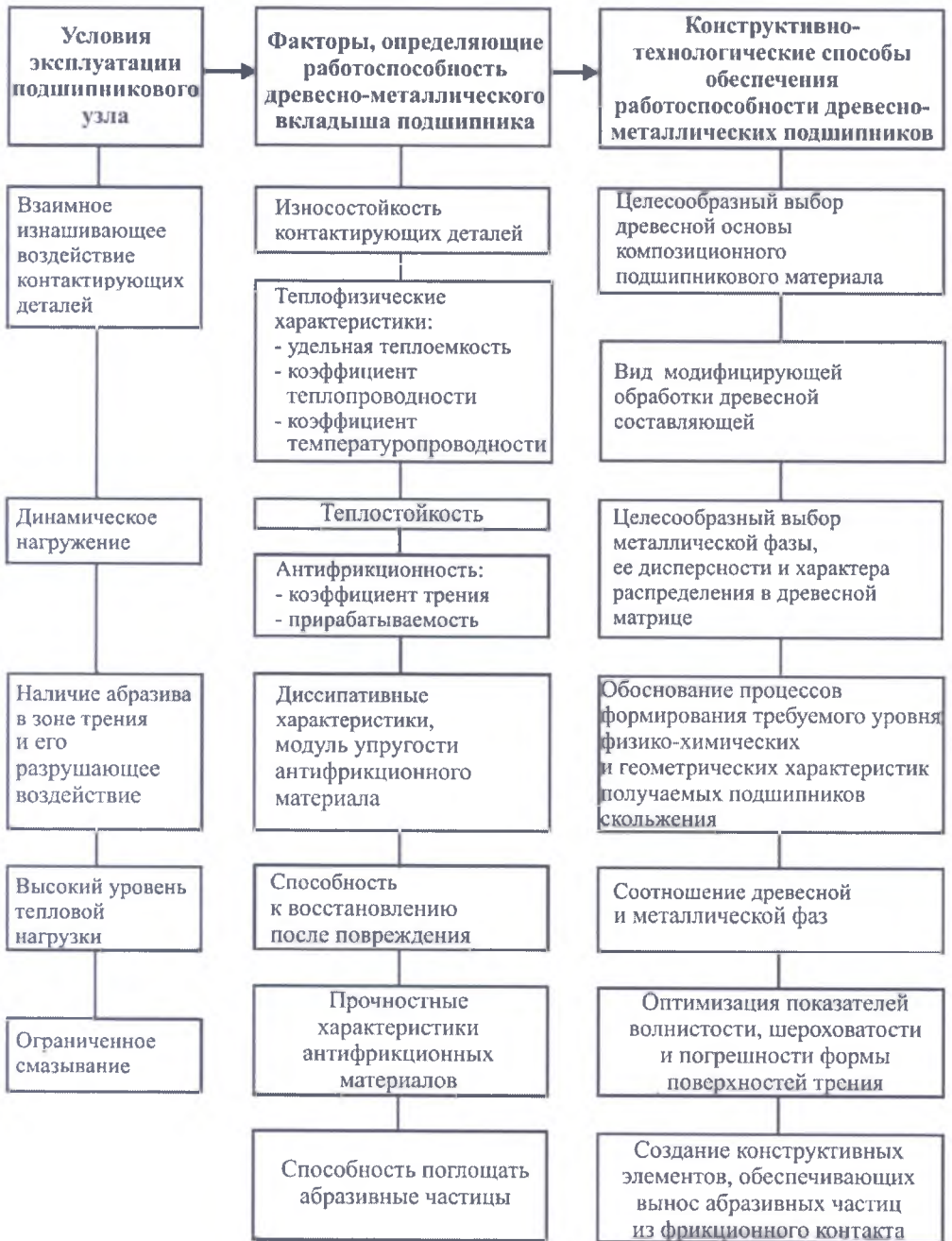
Рис. 1. Система взаимосвязи функциональных характеристик древесно-металлических подшипников скольжения и способы их достижения при проектировании и изготовлении
