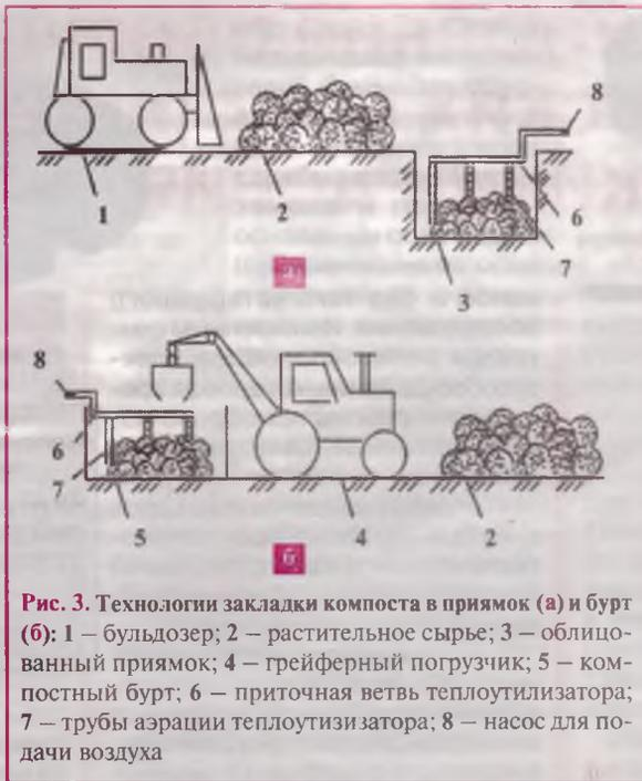
**Рис. 3.** Технологии закладки компоста в приямок (а) и бурт (б): 1 – бульдозер; 2 – растительное сырье; 3 – облицованный приямок; 4 – грейферный погрузчик; 5 – компостный бурт; 6 – приточная ветвь теплоутилизатора; 7 – трубы аэрации теплоутилизатора; 8 – насос для подачи воздуха
