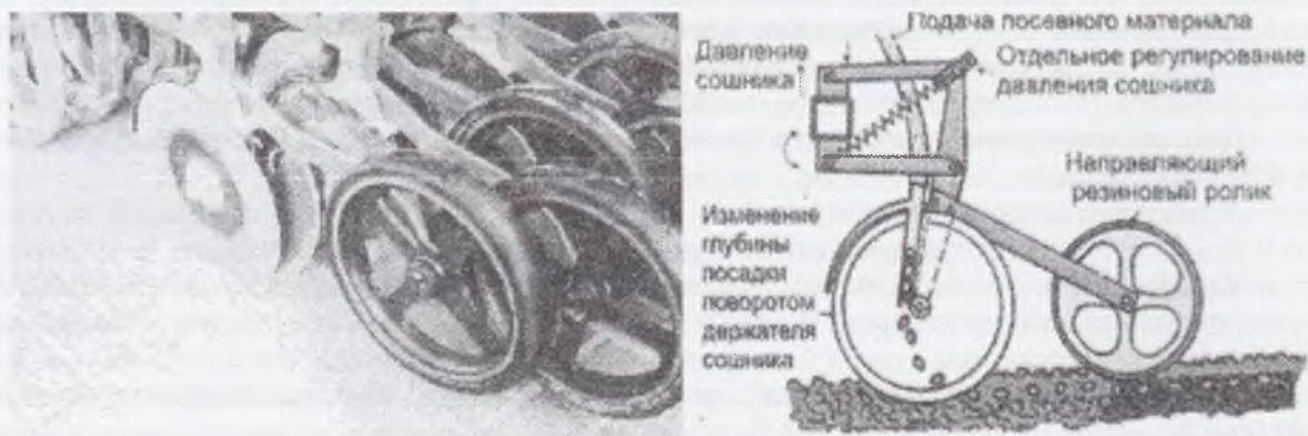
Рисунок 3 - Двухдисковый сошник с направляющим резиновым роликом
