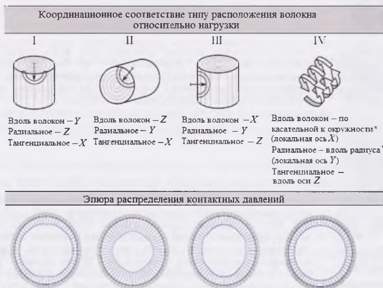
Рис. 3. Схемы расположения волокон древесины относительно внешней нагрузки во вкладышах подшипников и соответствующие им эпюры контактных давлений (*направления для каждого конечного элемента различны)
