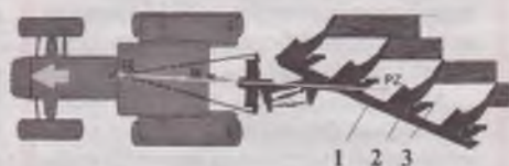
Рис. 3. Схема навески плуга: 1 — рама; 2 — корпус; 3 — рыхлитель плужной подошвы; TZ — центр трактора; М — середина задней оси; PZ — центр плуга
