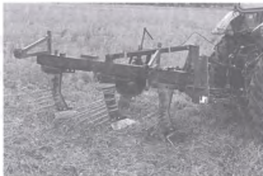
Рис. 3. Плуг ПЛН-3-35 с изготовленными корпусами и тензосцепкой
