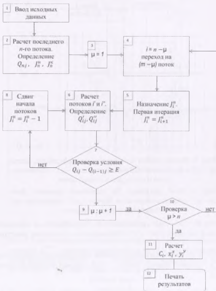
Рис. 2. Блок-схема алгоритма расчета комплексного объектного потока
