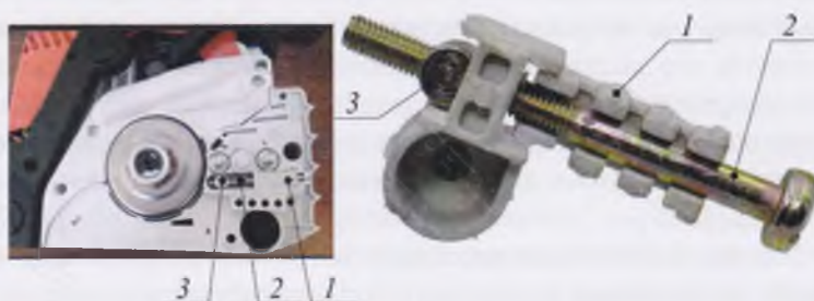
Рис. 2. Механизм для обычного натяжения пильной цепи
