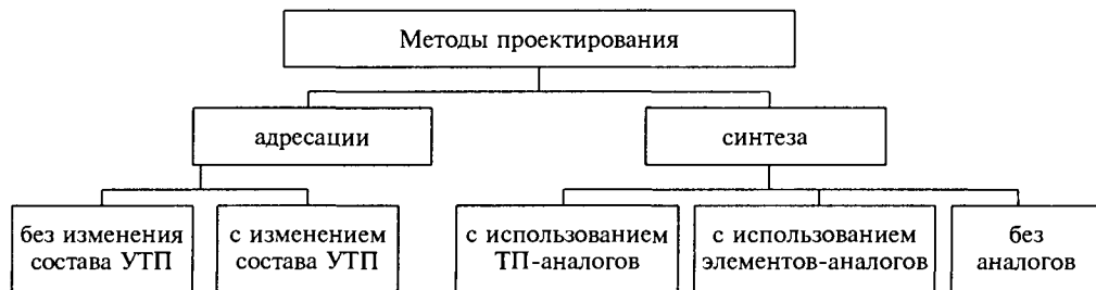
Рис. 4.1.20. Классификация методов проектирования состава и структуры ТП
