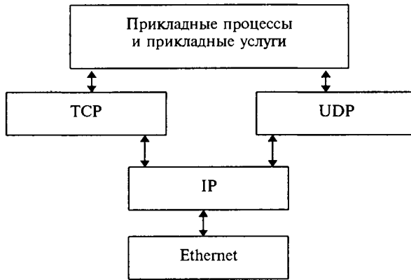
Рис. 4.5.21. Модель протоколов TCP/IP в системе коммуникационных услуг
