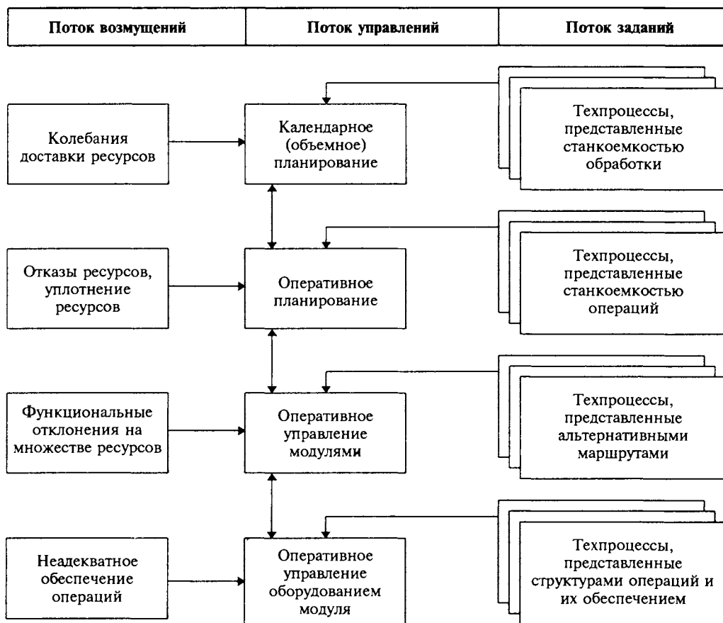
Рис. 4.5.24. Связь задач подсистемы функционального обеспечения системы программного обеспечения управления в ГПС
