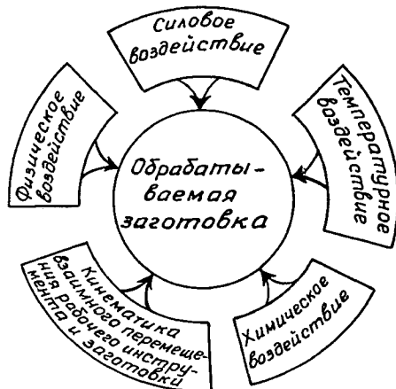
Рис. 2.10.1. Процесс обработки заготовки на любой операции
