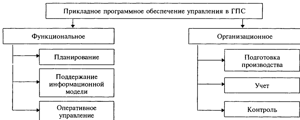
Рис. 4.5.23. Подсистемы программного обеспечения управления в ГПС
