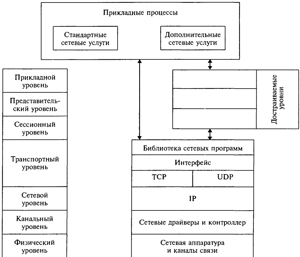
Рис. 4.5.22. Соответствие набора протоколов TCP/IP и модели взаимодействия открытых систем
