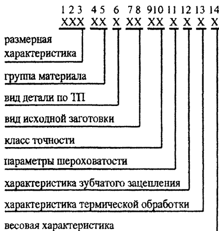
Рис. 1.3.3. Структура кода классификационных группировок технологических признаков
