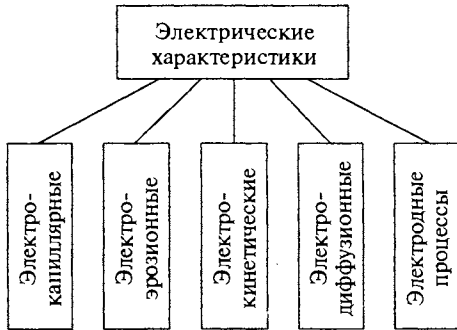
Рис. 2.2.20. Электрические контактные характеристики
