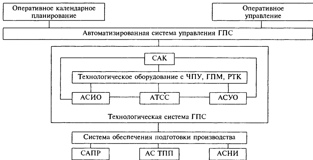
Рис. 4.5.3. Производственно-техническая структура ГПС
