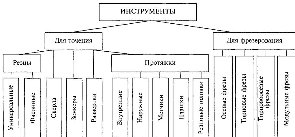
Рис. 3.3.1. Классификация инструментов для точения и фрезерования
