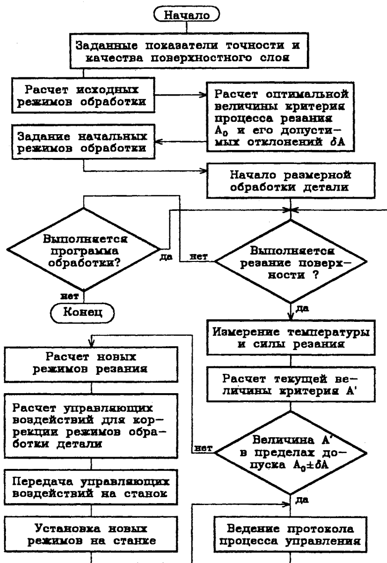
Рис. 2.1.6. Алгоритм работы автоматизированной системы управления
