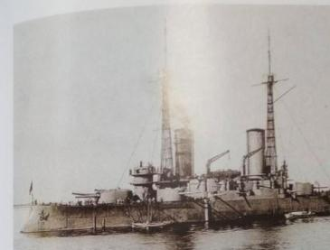
Экспериментальный броненосец «Император Павел I» с гребельными мачтами Шухова. Кронштадт. 1912 г.
